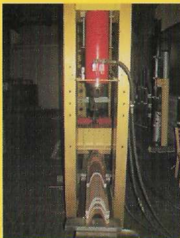
Prasa hydrauliczna do badań elementów obudów górniczych
