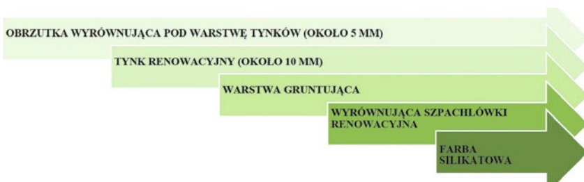
Ryc. 9. Etapy wykonywania tynków renowacyjnych (technologia WTA – kolejność nakładania warstw)
