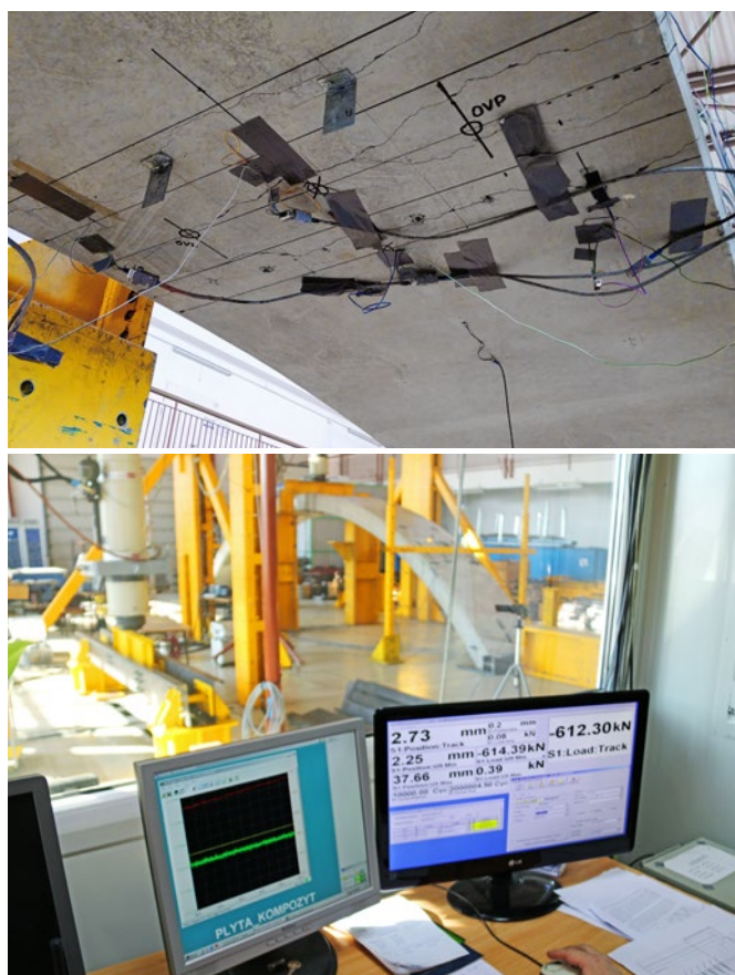
Ryc. 3. Rysy w kluczu łuku pod obciążeniem ok. 600 kN w modelu LS1
