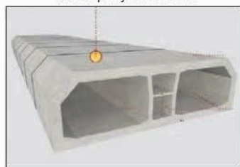
Typowy element tunelu, 8 x 22,5m
