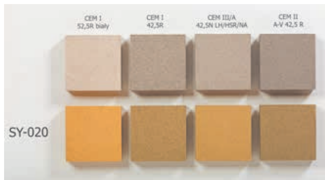
Ryc. 6. Wpływ koloru cementu na wybarwienie betonu. Rząd górny: próbki wzorcowe bez pigmentu; rząd dolny od lewej: pigment żółty SY-020 6,0% m.c. CEM I 52,5R biały, CEM I 42,5R, CEM III/A 42,5N, CEM II A-V 42,5R
