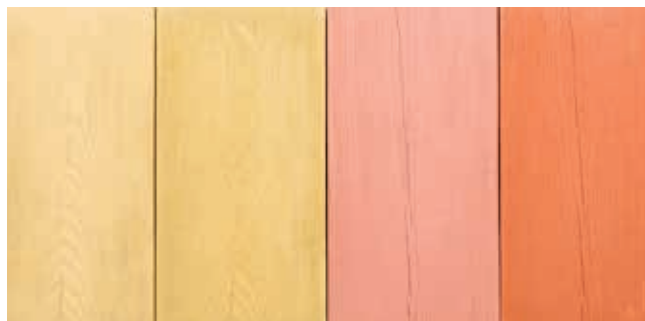
Ryc. 8. Wpływ koloru kruszywa na wybarwienie betonu, od lewej: pigment żółty SY-020 – kruszywo jasne, kruszywo ciemne, pigment czerwony SR-010 – kruszywo jasne, kruszywo ciemne
