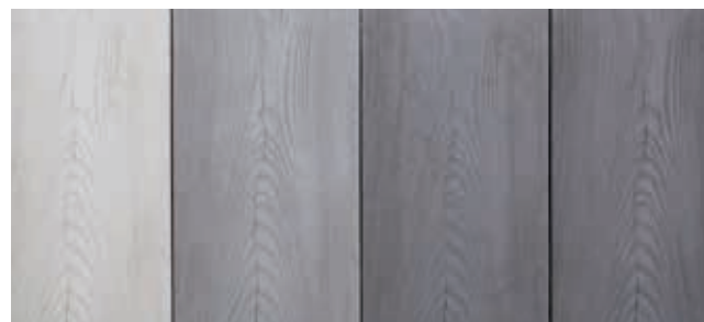
Ryc. 7a. Wpływ dozowania pigmentu antracytowego SD-950 na wybarwienie betonu, od lewej: 1% m.c., 4% m.c., 8% m.c., 12% m.c.
