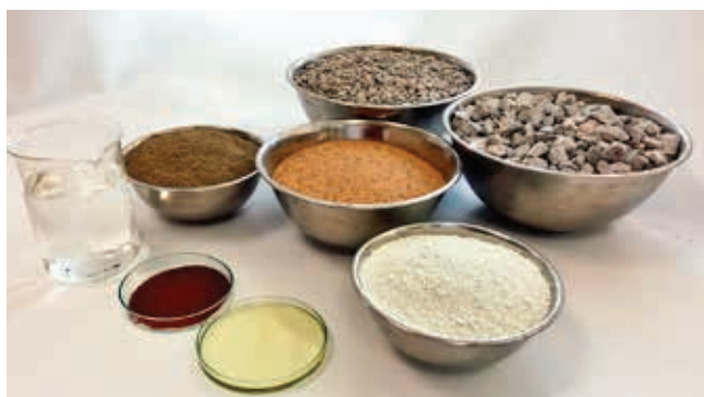
Ryc. 1. Składniki betonu – ich pochodzenie skutkuje zmiennością ich składu oraz wpływa na wybarwienie betonu
