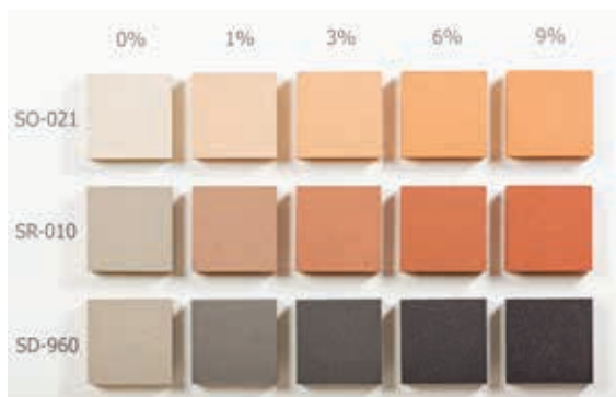
Ryc. 7c. Wpływ dozowania pigmentu na wybarwienie betonu, od lewej: próbka referencyjna bez dodatku pigmentu, 1% m.c., 3% m.c., 6% m.c., 9% m.c.
