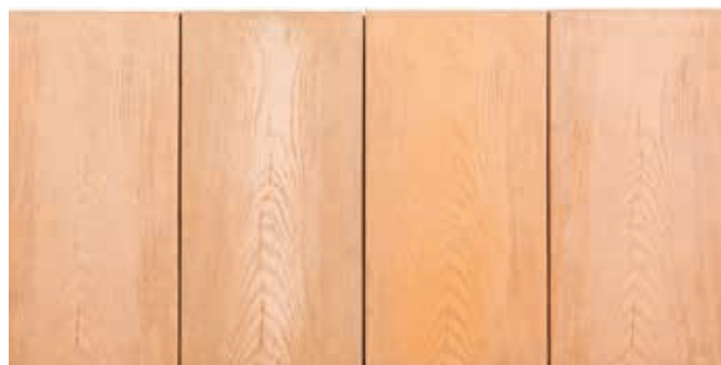
Ryc. 9. Wpływ współczynnika wodno-cementowego na wybarwienie betonu, pigment brązowy SB-007, od lewej: w/c = 0,65, w/c = 0,55, w/c = 0,45, w/c = 0,35
