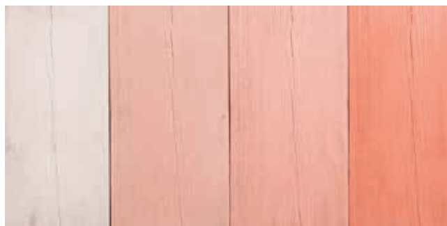
Ryc. 7b. Wpływ dozowania pigmentu czerwonego SR-010 na wybarwienie betonu, od lewej: 1% m.c., 4% m.c., 8% m.c., 12% m.c.
