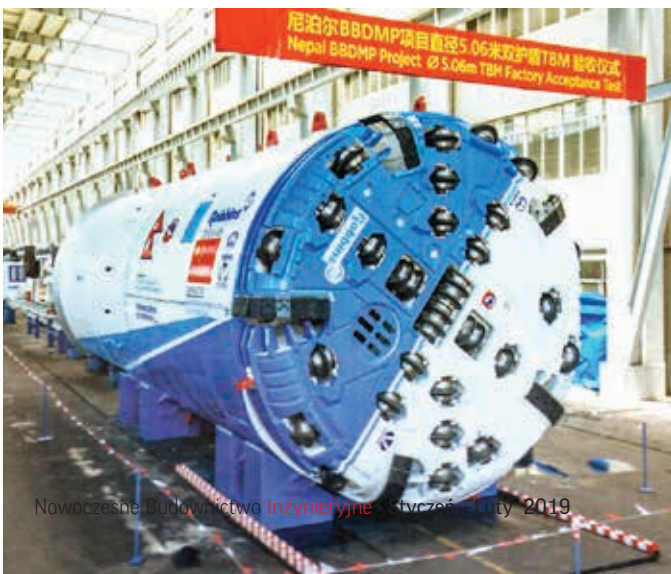
Ryc. 4. Głowica TBM firmy Robbins przygotowana do wydrążenia tunelu pod pasmami górskimi Siwalik w Nepalu [5]
