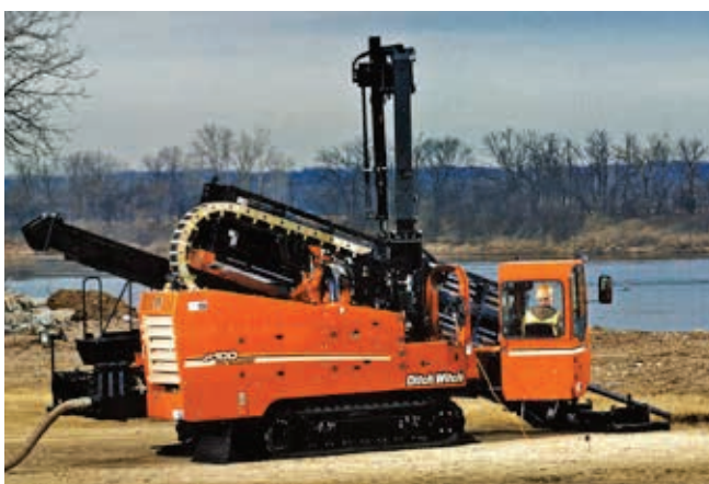
Ryc. 8. Maszyna do wiercenia kierunkowego firmy Ditch Witch [1]
