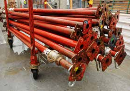
Podpory stalowe umieszczone na barełce
