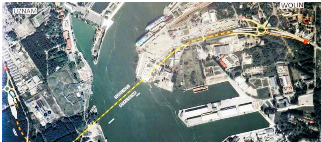
Trasa przebiegu tunelu
