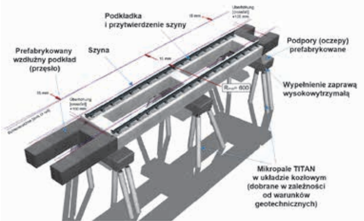
Ryc. 7. Schemat konstrukcji nawierzchni bezpodсыpkowej systemu NFF, za: [4]
