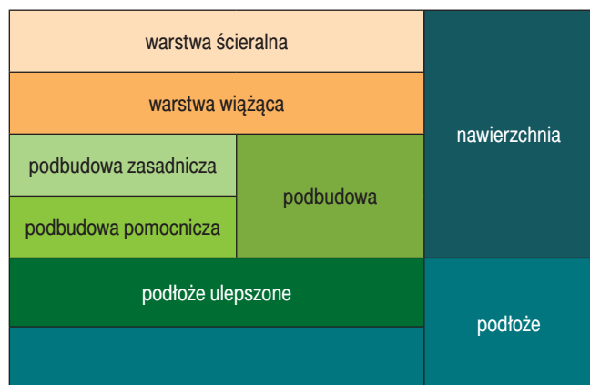
Ryc. 1. Schemat konstrukcji nawierzchni drogowej [3]
