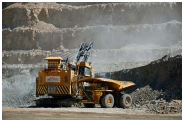
Ryc. 16. Koparka Caterpillar 7495 o pojemności łożki 55 m 3 oraz wozidło Komatsu 930E-4 o ładowności 300 t [23]
