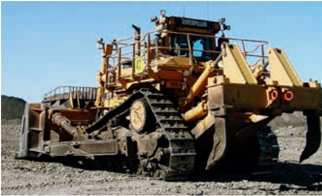
Ryc. 10. Spycharka Caterpillar D11R z osprzętem zrywającym do urabiania mechanicznego gruntów i podłoża skalnego [15]
