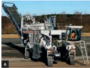
Ryc. 12: a) Kombajn frezujący Wirtgen 4200SM, b) widok na bęben frezujący kombajnu [27]
