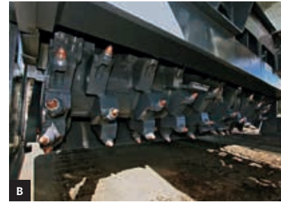
Ryc. 12: a) Kombajn frezujący Wirtgen 4200SM, b) widok na bęben frezujący kombajnu [27]
