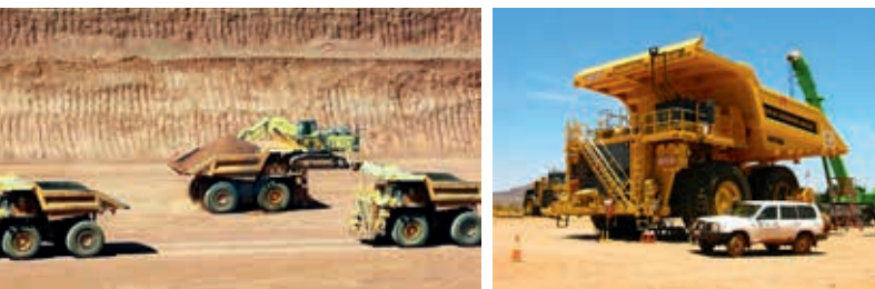
Ryc. 15. Autonomiczne samochody technologiczne w trakcie testów w kopalni West Angelas (Rio Tinto, Australia) [25, 31]
