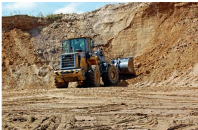
Ryc. 14. Praca ładowarki XCMG ZL50G podczas eksploatacji złoża piasków, fot. A. Borcz
