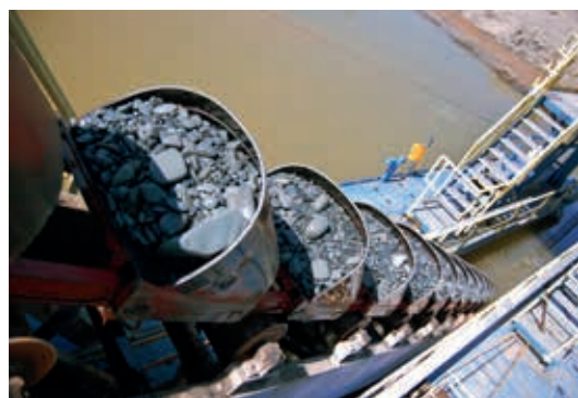
Ryc. 16. Pogłębiarka wieloczerpakowa w kopalni kruszyw żwirowych eksploatowanych spod wody, fot. A. Borcz
