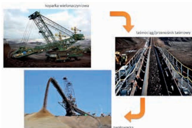
Ryc. 4. Układ KTZ w kopalni węgla brunatnego, fot. A. Borcz [10, 12]
