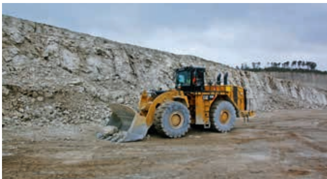
Ryc. 8. Jednoślukowa ładowarka na podwoziu oponowym – Caterpillar 990K, fot. A. Borcz
