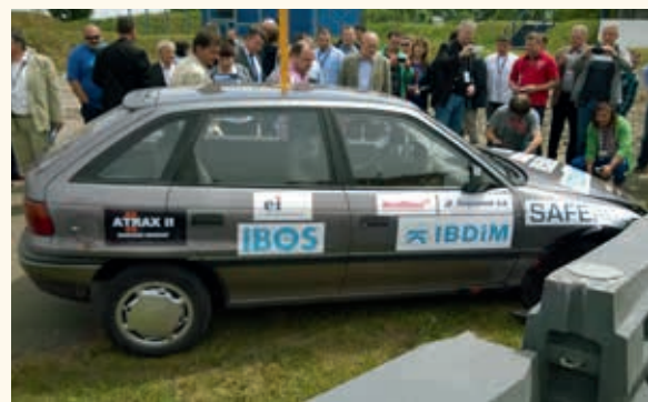
Pojazd po uderzeniu w połączenie bariery stalowej i betonowej FLEXTRA
