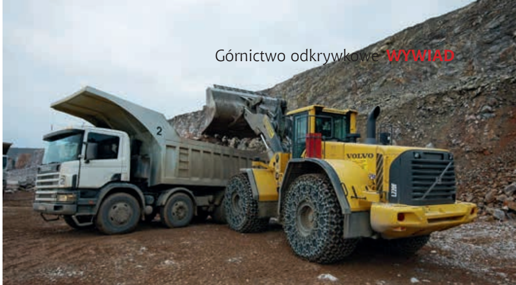
Ładowarka tyżkowa przy pracy w kopalni odkrywkowej, fot. WGiG AGH
