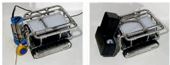
Robot inspekcyjny – inspekcja dna zbiornika
