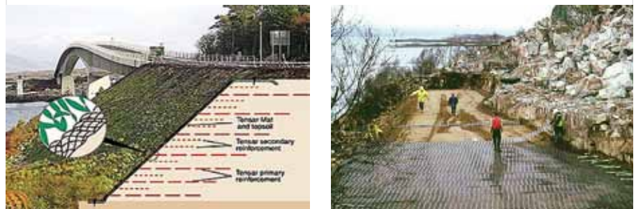
Ryc. 19. Zabezpieczanie skarpy konstrukcją oporową z gruntu zbrojonego
