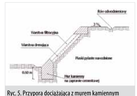
Ryc. 5. Przypora dociążająca z murem kamiennym
