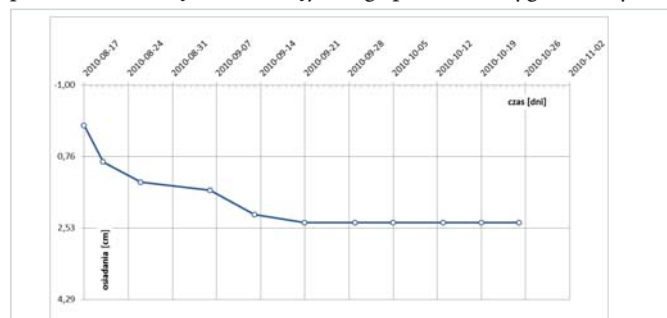
Ryc. 8. Przykładowy wykres osiadania reperu na podłożu wzmocnionym kolumnami DSM-d
