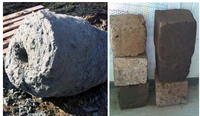
Ryc. 5. Odcinek związanej kolumny DSM-d oraz wycięte z niej próbki sześciennie
