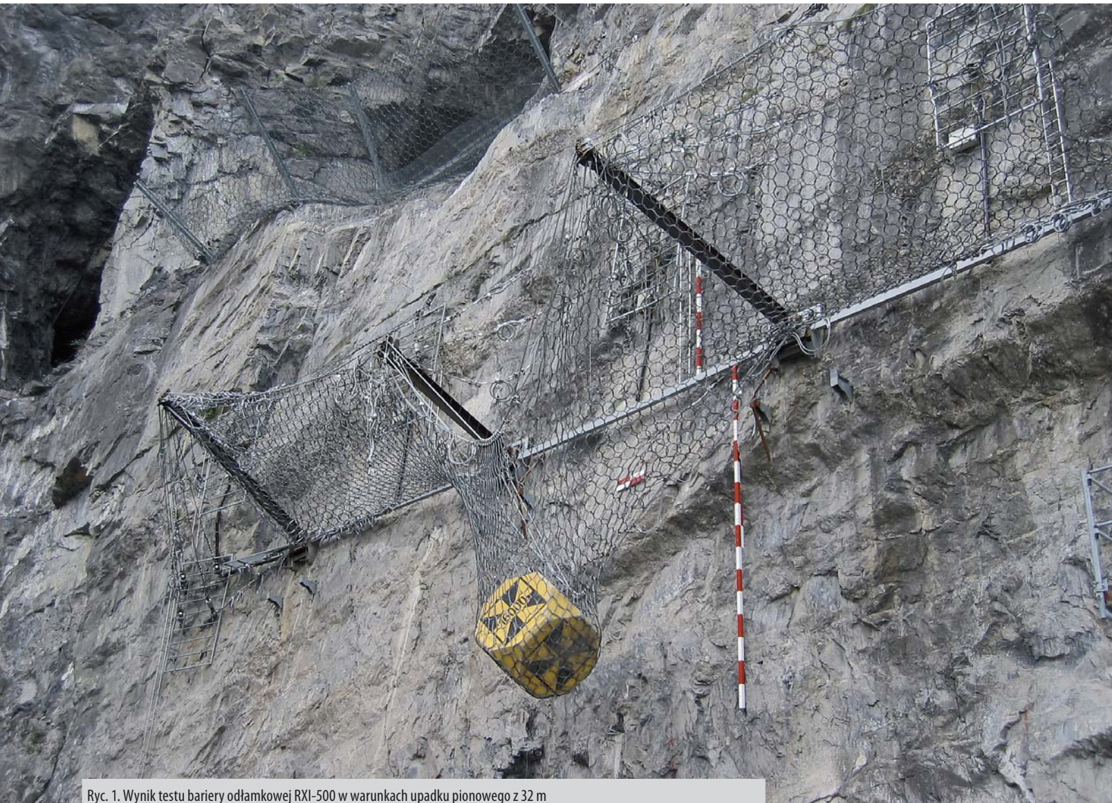
Ryc. 1. Wynik testu bariery odłamkowej RXI-500 w warunkach upadku pionowego z 32 m
