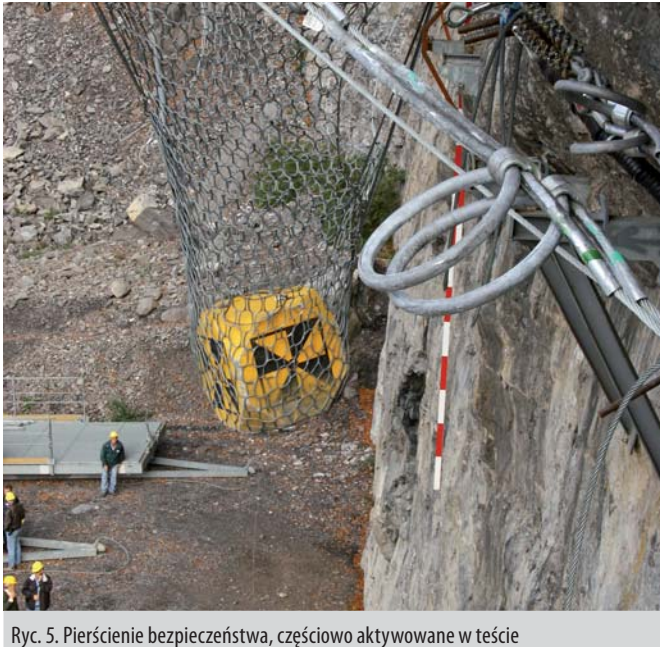
Ryc. 5. Pierścienie bezpieczeństwa, częściowo aktywowane w teście
