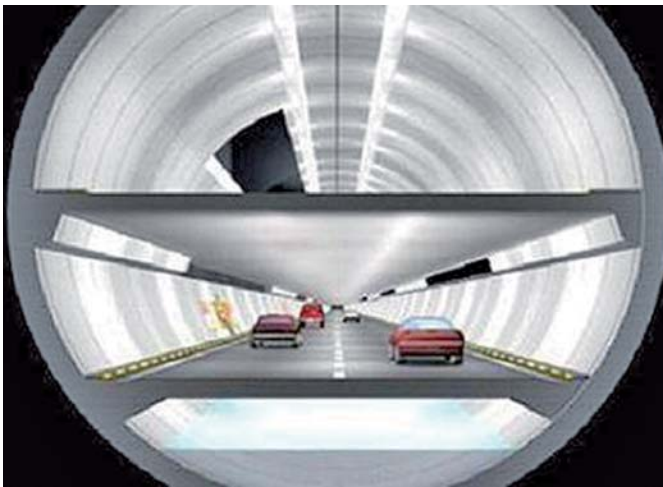
Ryc. 4. Przekrój poprzeczny tunelu
