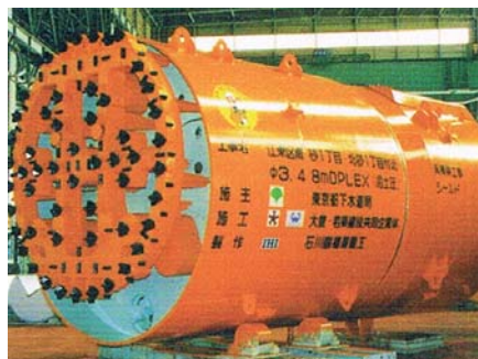
Ryc. 7. Urządzenie tarczowe DPLEX wykorzystane do przebudowy tunelu Minamisuna w Tokio [4]
