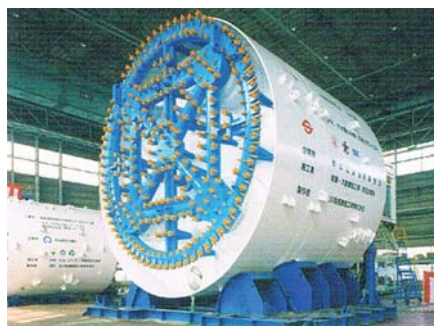
Ryc. 8. Urządzenie DPLEX użyte do budowy tunelu metra Teito w Tokio [4]
