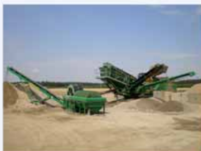
Dwa- lub trzypokładowe mobilne przesiewacze, na mokro lub na sucho, z silnikiem elektrycznym lub typu diesel
