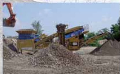
Zestaw do recyklingu (krusząca-separator magnetyczny-przesiewacz -rozdrabniacz)
