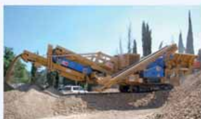
Mobilna kruszarka udarowa z przesiewaczem i taśmociągami nawrotnym
