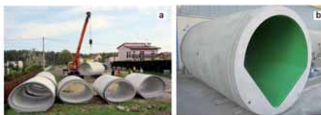
Ryc. 6. Betonowe rury przepustowe: a) nowoczesny przekrój gardzielowy zwiększający światło poziome przepustu, b) przykład rury z profilowaną częścią odpływową oraz dodatkową warstwą wewnętrzną z tworzywa sztucznego poprawiającą własności hydrauliczne, fot. Haba-Beton Sp. z o.o.
