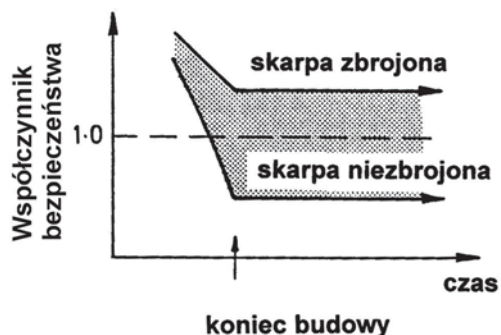
Ryc. 14. Wpływ zbrojenia geosyntetykiem na współczynnik bezpieczeństwa skarpy [9, 10]
