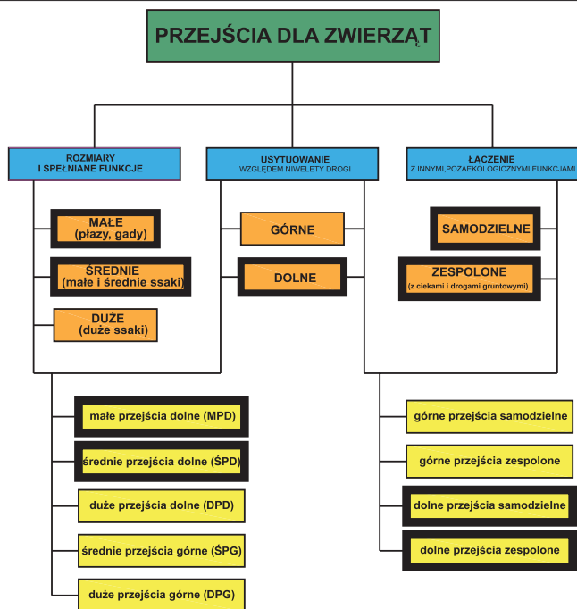
Ryc. 2. Podział przejść dla zwierząt. Grubymi ramkami oznaczono rodzaje przejść, do budowy których wykorzystać można konstrukcje przepustów
