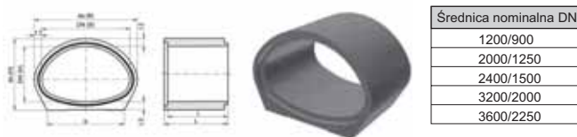
Ryc. 6. Przykład nowoczesnych elementów żelbetowych (o kształcie gardzieliowym) firmy Haba-Beton Sp. z o.o. do budowy przepustów
