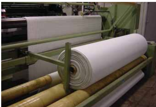
Rulon materiału przeznaczony do uszycia rękawa z widocznym zbrojeniem z włókien szklanych
