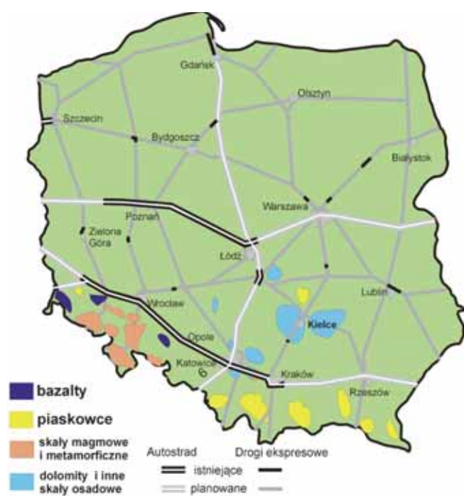
Rys. 1. Ważniejsze regiony występowania surowców skalnych do produkcji kruszyw łamanych na tle sieci dróg ekspresowych i autostrad
