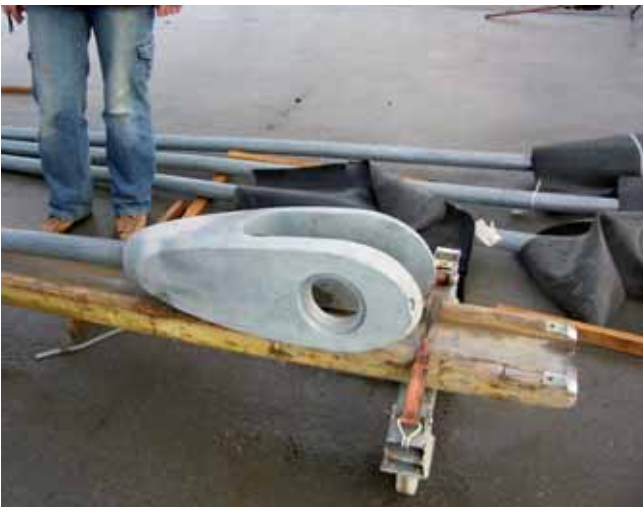
Ryc. 9. Most lukowy WD161 nad autostradą A2 węzeł Koło obok Konina. Zakończenie linowe bierne. Głowica widlasta zalewana
