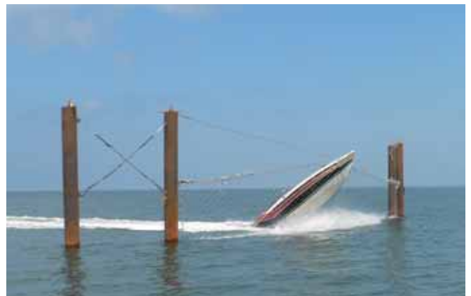
Ryc. 7. Bariera chroniąca przed atakami terrorystycznymi z użyciem szybkich łodzi motorowych. Na rycinie test bariery przy wykorzystaniu łodzi o masie 3500 kg rozpędzonej do 38 węzłów (ok. 70 km/h). Bariera opracowana na potrzeby US Navy
