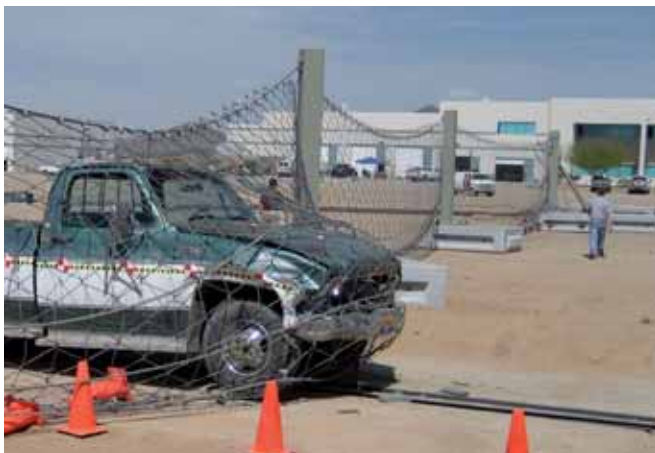
Ryc. 6. Bariera dynamiczna jako ochrona granicy USA z Meksykiem. Na rycinie pokazano wynik testu z ciężarówką o masie 4500 kg, rozpędzoną do 65 km/h
