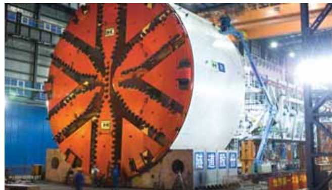
Rys. 3. Największa tarcza TBMs firmy Herrenknecht Ø 15,43 m [2]
