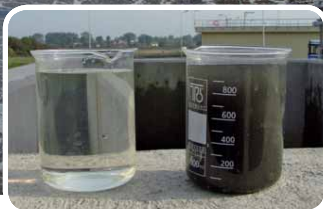
Ścieki z płaszowskiej oczyszczalni, po i przed oczyszczeniem
