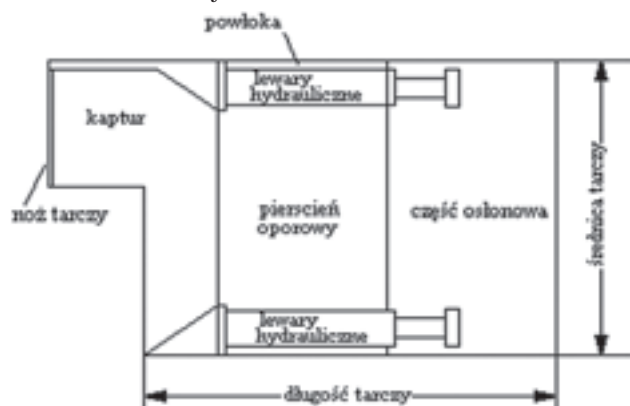
Rys. 1. Typowa tarcza do drążenia tuneli i jej główne elementy składowe
