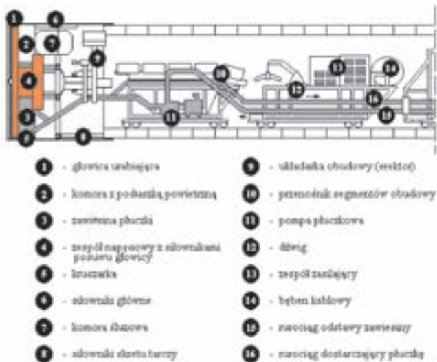
Rys. 10. Przekrój tarczy zawieszinowej
