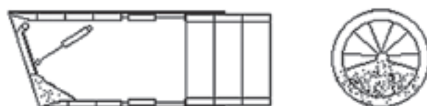
Rys. 2. Tarcze otwarte – urabianie ręczne
