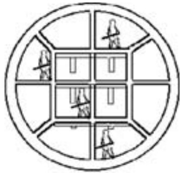
Rys. 3. Tarcza z ręcznym urabianiem calizny
