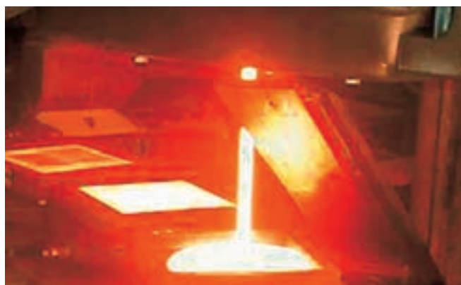
Ryc. 4. Proces wlewania roztopionego bazaltu do formy
