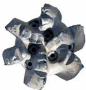
Ryc. 5. Zużyty świder PDC Smith
