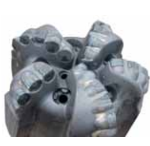
Ryc. 6. Zużyty świder PDC Dominat
