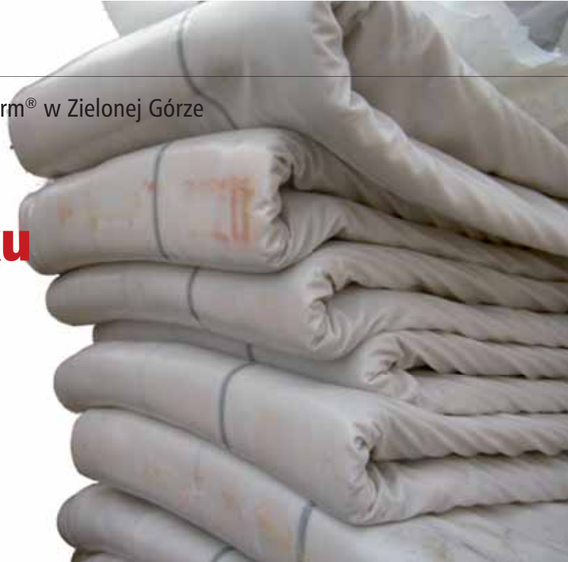
Rękaw Insituform® dostarczony na miejsce renowacji
