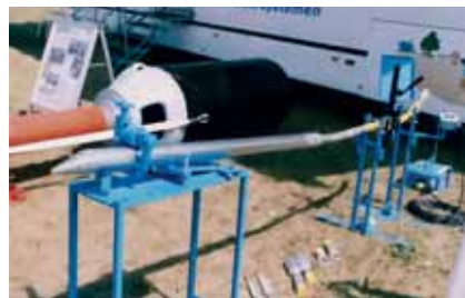
Rys. 16. Sterowany przebijak pneumatyczny firmy Tracto Technik umieszczony w łożu (urządzenie na pierwszym planie)
