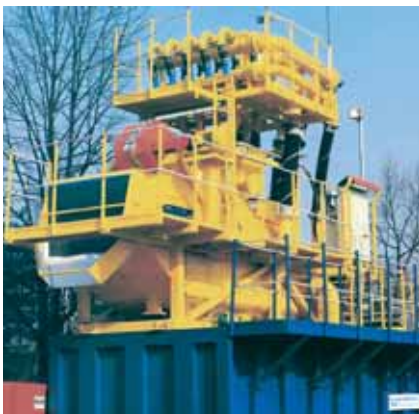
Rys. 11. Zespół urządzeń służących do separacji płuczki [7]
