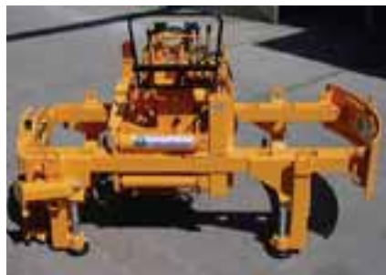
Rys. 11. Wiertnica do przecisków hydraulicznych z wierceniem pilotowym [7]
