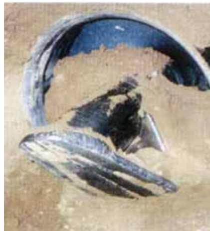
Rys. 14. Wiertło ślimakowe specjalnie ukształtowane, zakończone skośną płytką sterującą [2]
